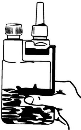
3) Dosierkammer durch Drücken des Behälters füllen / Remplir la chambre de dosage en pressant sur le flacon.
