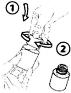
Setzen Sie den Verschluss auf die Flasche (1) und drehen Sie diesen fest zu (2). Wenn Sie jetzt den Verschluss wieder aufdrehen, bleibt der Adapter auf der Flasche.
